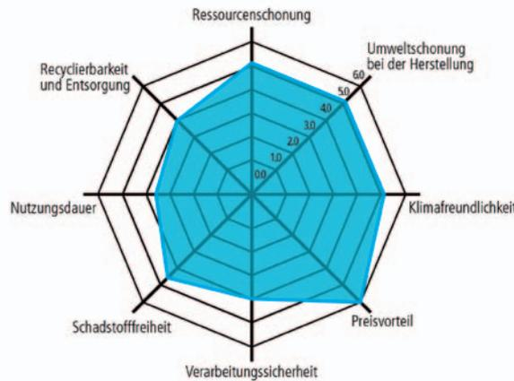
Das Spinnendiagramm einer EPS-Hartschaumplatte 25, Standard 22 cm: Ausgangslage für die Messung war ein begehbare und begrüntes Flachdach mit einem U-Wert von 0,15 W/mK ohne besondere Lasten und Merkmale. (Grafik: Swisspor)
