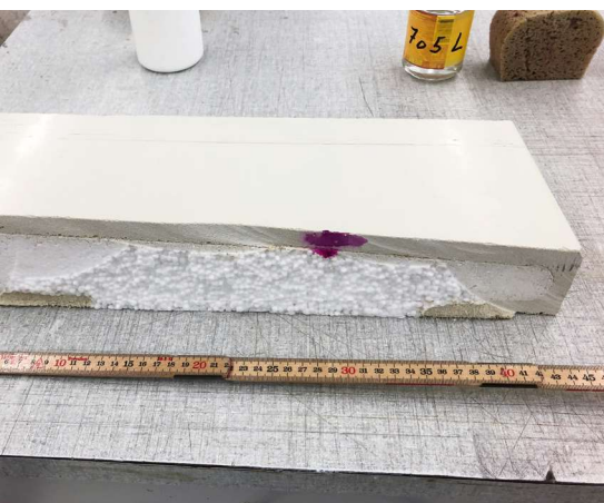
Formbauteile aus Faserbeton sind aus energetischen Gründen rückseitig mit Isolationsmaterialien verbunden.
