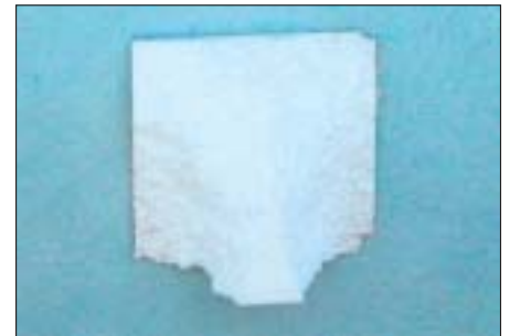
3.1.1.2 Die Bruchebene liegt im Dämmstoff. Der Untergrund weist eine gute Tragfähigkeit auf. (Bild Greutol AG)
