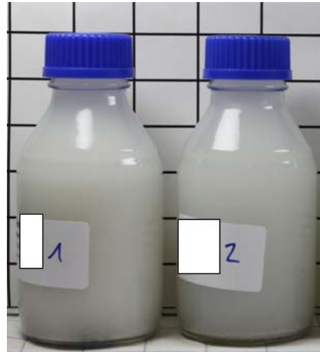
Beispiel missglückte Spaltung Links: vorher. Rechts nachher
