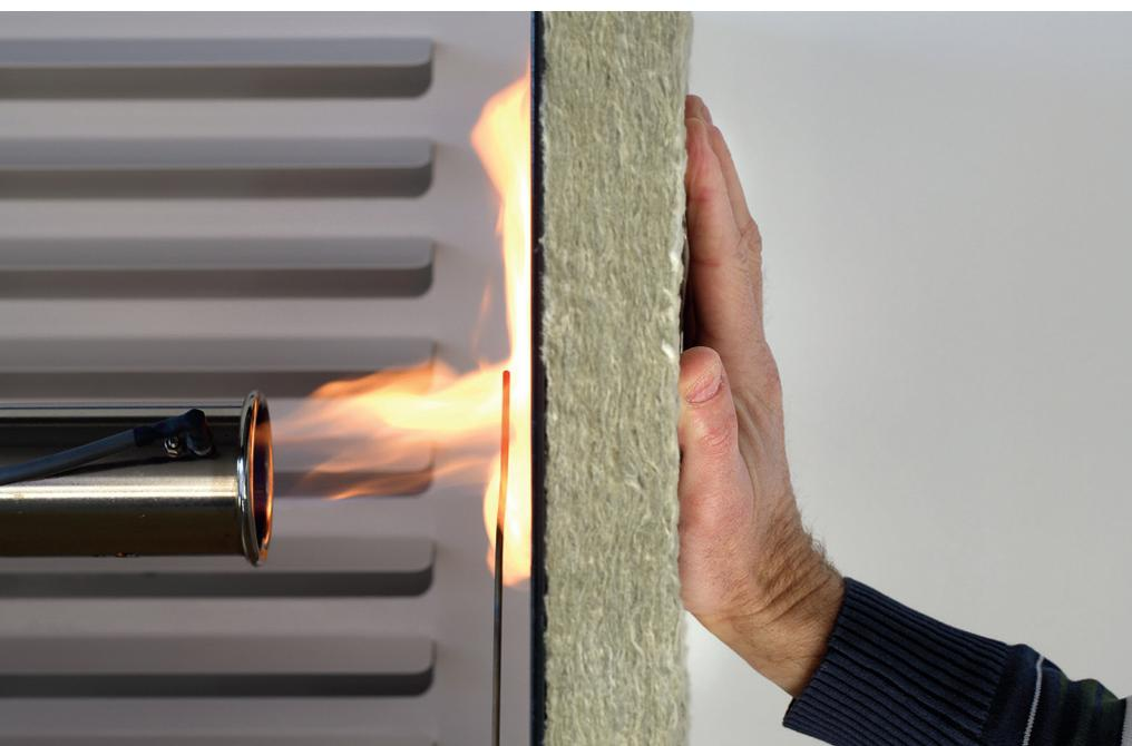
Die vollflächige Dämmung der Aussenwand mit Steinwolle garantiert einen konsequenten Brandschutz.
