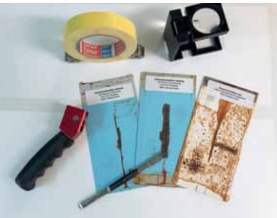
Auswertung von Salzsprühplatten.
