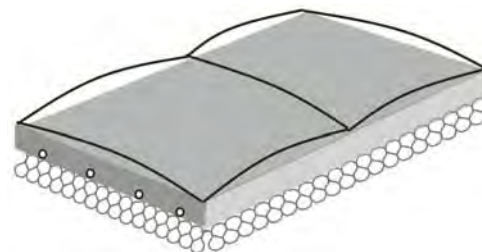
Abb. 10: Rückverformung mit querlaufendem Riss.
