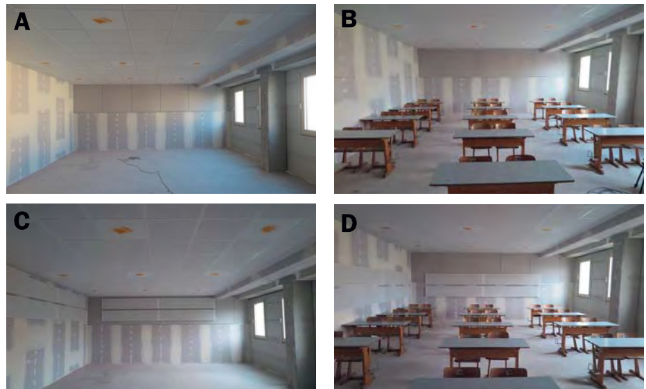
Abb. 3: Beispielhafte Raumsituationen: A: Raum mit Akustikdecke ohne Möblierung, ohne Wandabsorber, B: Raum mit Akustikdecke mit Möblierung, ohne Wandabsorber, C: Raum mit Akustikdecke ohne Möblierung, mit Wandabsorbem «unter der Decke», D: Raum mit Akustikdecke mit Möblierung, mit Wandabsorbem auf «Ohrhöhe» (entspricht Mikrofonhöhen innerhalb der Ober- und Unterkante der Wandabsorber).
