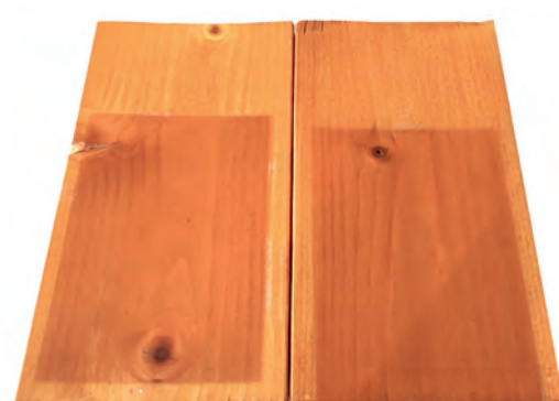
Zwei Holzlasuren nach 1000 Stunden im QUV-Prüfgerät.
