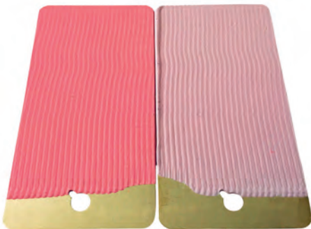
Linkes Muster vor Lichtbeständigkeitsprüfung; rechtes Muster danach.
