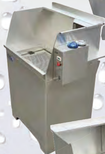
Vollautomatische Anlage, 400 Liter/h, Betriebsgröße bis zu 10 Mitarbeiter
