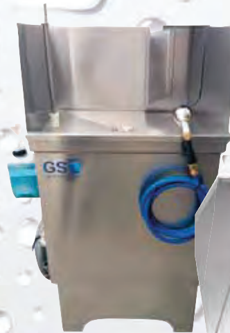
Manuelle Anlage, 330 Liter/h, Betriebsgröße bis zu 3 Mitarbeiter
