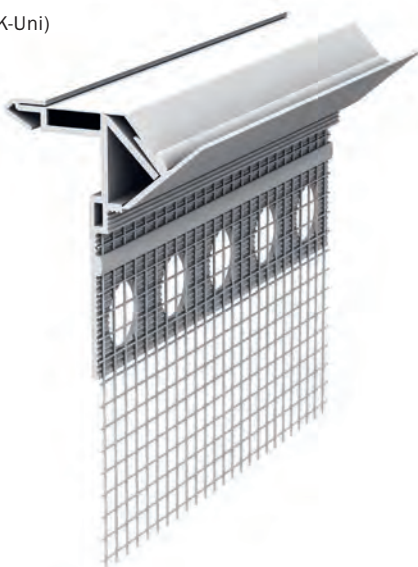
Blechanschlussprofil für den An-/Abschluss einer Putzfläche zum Bei- spiel bei Blechhochzügen. (Bild: APU AG)
