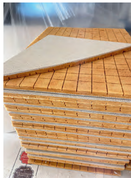
Die eingefrästen Akustikplatten.
