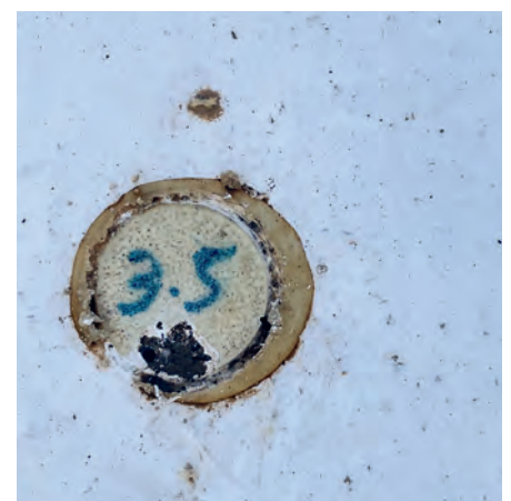
Haftzugtest. 1,5 N/mm 3 sind als Faustregel gefordert.
