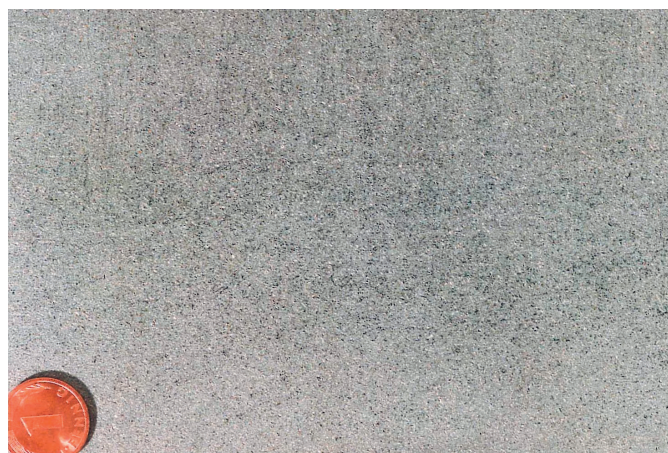
Norm-Reinheitsgrad Sa 2.5 – ausgehend von Rostgrad A: Zunder, Rost und Beschichtungen sind so weit entfernt, dass Reste lediglich als leichte Schattierungen infolge der Tönungen von Poren sichtbar bleiben.
